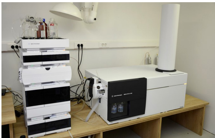
Agilent 6500 LC/MS Q-TOF system can be used to identify unknown compounds. Image: InnoRenew CoE / Za določanje neznanih spojin lahko uporabimo sistem Agilent 6500 LC/MS Q-TOF. Foto: InnoRenew CoE
